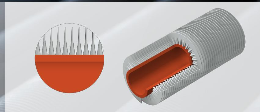
**Typ S-Fin** ist ein Rippenrohrtyp, bei dem die Rippe durch Hochfrequenzschweißung mit dem Rohr verbunden wird. Dieses Rohr kann sowohl zur Erhitzung als auch zur Kühlung eingesetzt werden. Aufgrund der glatten Rippenflanken verursacht das S-Fin-Rohr sehr geringe luftseitige Druckverluste und lässt daher hohe Strömungsgeschwindigkeiten zu. Die fertigungsbedingte große Rippenteilung resultiert ausserdem in einer geringeren Verschmutzungs-Anfälligkeit.
