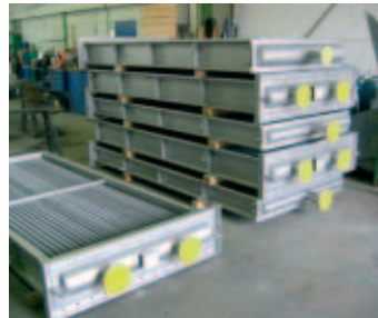
Mehrstufige dampfbetriebene Rippenrohrwärmeaustauscher mit Kondensatunterkühlung
