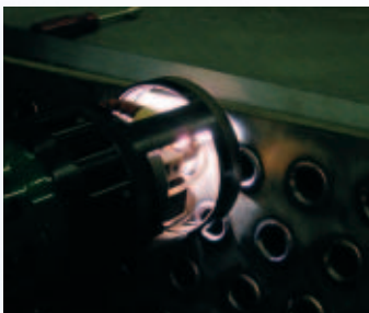
Einschweißen der Rohre mit einer Orbitalschweißmaschine
